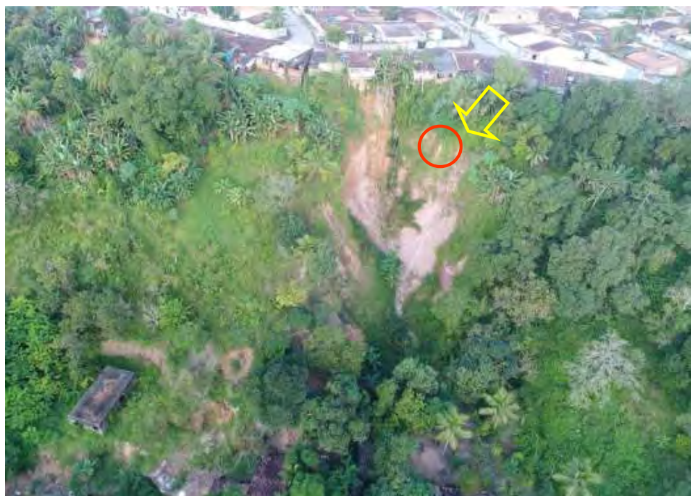
Figura 22.3 .-Vista aérea da encosta, a seta indica o ponto de lançamento de água, contribuições não identificadas.
